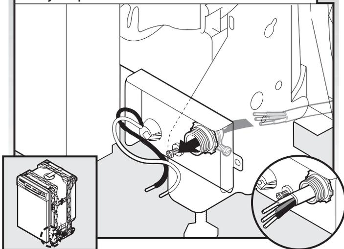
Installer le câble d'alimentation de telle manière qu'il ne soit pas en contact avec le moteur du lave-vaisselle, jusqu'à la partie inférieure de la cuve du lave-vaisselle. Introduire le câble dans le boîtier de connexion à travers le connecteur de conduit.
